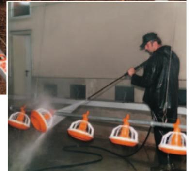
Higiene - un tema de importante. Dirigir el chorro de agua a presión hacia el plato. Éste empieza a rotar y así se limpia eficientemente y en profundidad.
